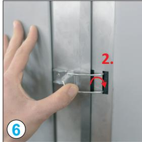
**Fertig spannen:** dann alle Verschlussbügel vom linken (1.) in den rechten Schlitz (2.) umhaken und verschließen, damit die Endspannung erreicht wird.
