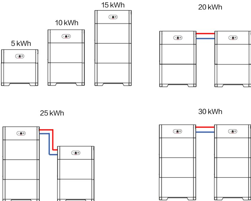
— Signalkabel — DC-Eingangskabel IB01W00008
