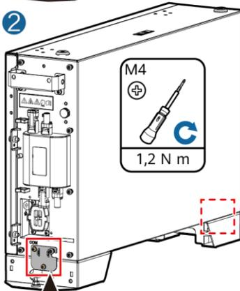
Befestigen Sie die Verbindungsteile auf beiden Seiten mit den vier Schrauben.
