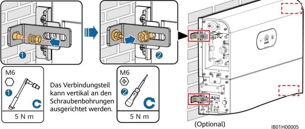
3. (Optional) Befestigen Sie die Akkuerweiterungsmodule an der Wand wie in Schritt 2 beschrieben.
