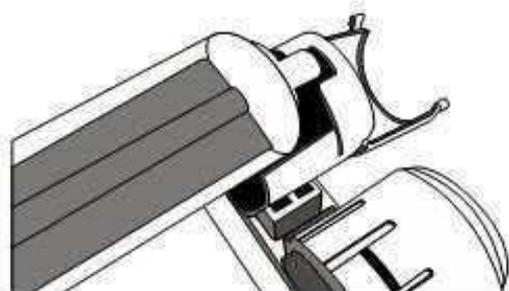
Nach Einschieben der Röhre in den Sammlerkasten wird diese dann in den dazugehörigen Fußhalter eingesteckt und dieser geschlossen.
