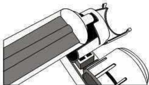
Nach Einschleiben der Röhre in den Sammlerkasten wird diese dann in den dazugehörigen Fußhalter eingesteckt und dieser geschlossen.
